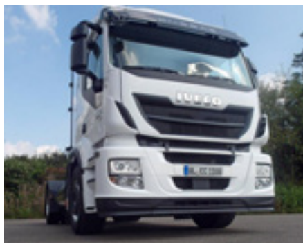
Der Iveco Stralis LNG fährt mit flüssigem Erdgas.
